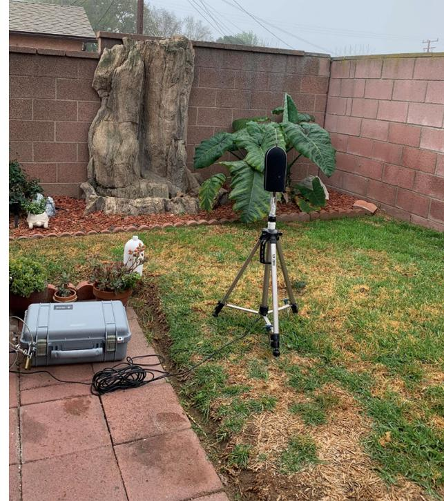
La configuración del equipo consiste en una caja del tamaño de un maletín y un trípode de cámara con micrófono.
